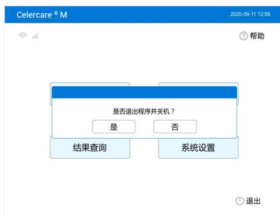
然后，关闭分析仪后部的电源开关完成关机操作。分析仪关机后 10 秒内请勿再次开机。
