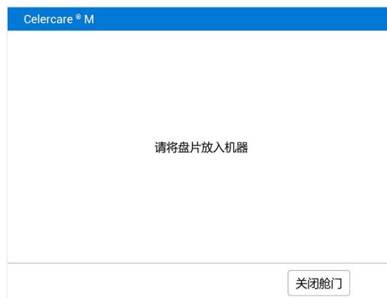
将已按照“3.2试剂盘的准备”内容加好样本和稀释液的待检试剂盘放入舱内，将试剂盘内圈的卡齿对准盘片连接器的缺口，使两者完全吻合，发出“咔”的声响表明盘片卡合到位，按压盘片边
