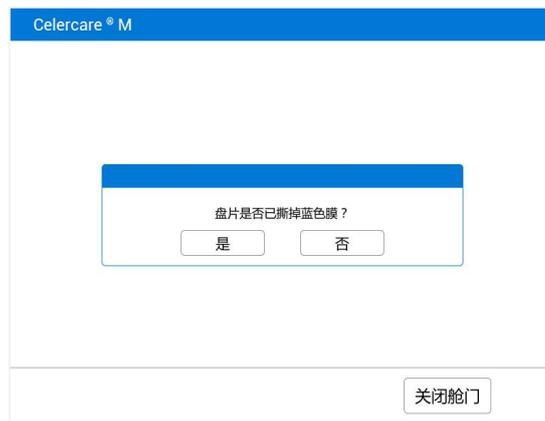
**注意：撕去保护薄膜后请勿触及盘片上表面比色孔周围区域，以防沾染污渍，影响检测准确性。
