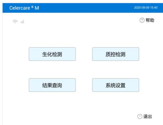
**提示：** 分析仪显示屏为电容触摸屏，所有按钮均可直接点击屏幕进行操作。
